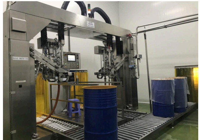
Trạm chiết rót vô trùng vào thùng phuy cho nước quả cô đặc xuất khẩu. Ảnh tư liệu Kim Nguyễn.
