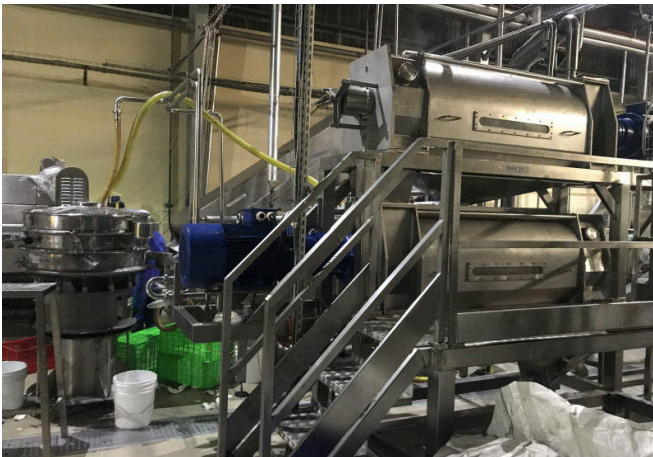
Dây chuyền chế biến nước trái cây: cụm ép, sàng rung và băng tải, chế tạo tại Ý.
