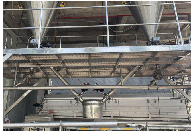
Tầng trên của máy sấy với các phễu cấp liệu, chế tạo tại Hà Lan.
